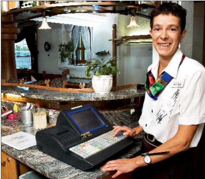
Das Kassensystem mit fünf Touchscreen-Kassenstationen von «Schultes» ist via Schnittstelle mit dem Hotelprogramm «Gastrodat» verbunden, so dass die Konsumationsbeträge der Hotelgäste automatisch auf die Zimmerrechnung transferiert werden.
